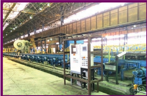
میزهای غلطکی انتقال دهنده ریل از بستر خنک کننده به ماشین صافکاری - عکاس:عباس فرشادپور
