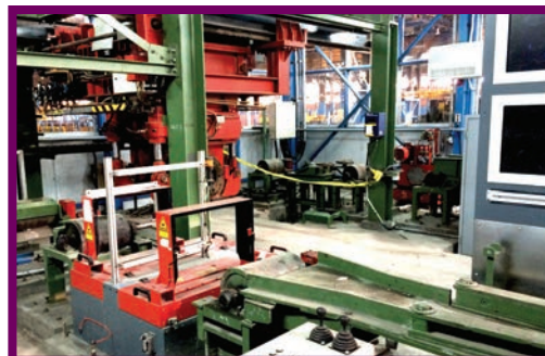
دستگاه پرس جهت رفع اعوجاج ریل - عکاس: نادر کرمی
