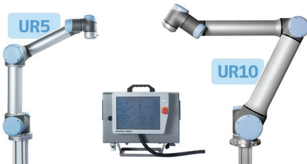
اندازه کوچک کنترلر و Teach pendant بسیار ساده ربات‌های شرکت Universal Robots
