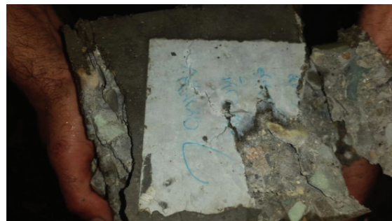
شکل ۳- نحوه شکست نمونه حاوی الیاف پلی پروپیلن تحت آزمایش مقاومت فشاری
