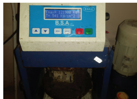
شکل ۲- نمونه تحت آزمایش فشاری بتن
