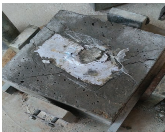
شکل ۵- نحوه شکست نمونه حاوی الیاف پلی پروپیلن
