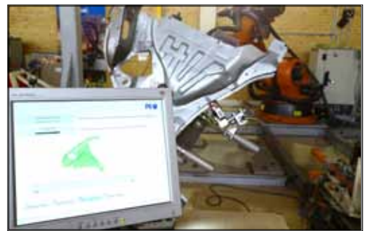
شکل ۴- ربات در موقعیت Part Inspection
