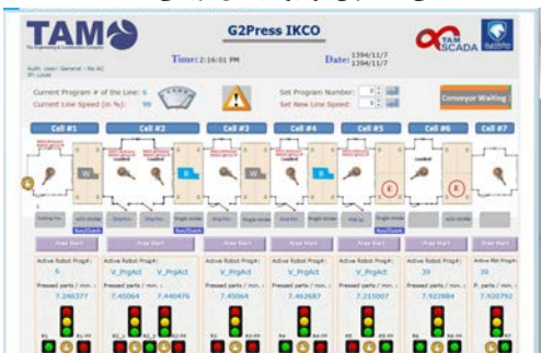
یکی از صفحات HMI نرم افزار تام اسکادا در خط پرس (در حال نمایش اطلاعات اصلی خط تولید)
