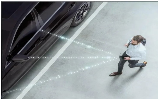
باز کردن در خودرو توسط تلفن همراه مجهز به فناوری UWB
