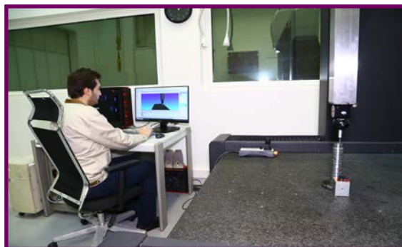
مقایسه قطعه با مدل سه بعدی آن در نرم افزار CMM
